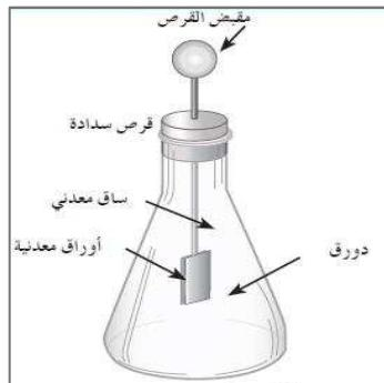
اداة تستخدم في الكشف عن الشحنات الكهربائية.
