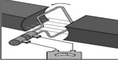
**\*\* الشكل يمثل تركيب المولد الكهربائي يتصل مع دائرة الحمل الخارجية. أجب :**
