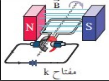
مبدأ عمل المحرك الكهربائي :
