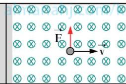
1- مجال مغناطيسي منتظم مقداره  $T(0.2)$  واتجاهه عمودي داخل الورقة دخل هذا المجال المغناطيسي جسيم مشحون بشحنة  $\mu C(2)$  وبسرعة منتظمة  $m/s(200)$  وباتجاه مواز لسطح الورقة باتجاه اليمين كما بالشكل
