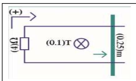
2- موصل طوله 0.25m يتحرك على سكة مغلقة بمقاومة ثابتة  $4\Omega$  في مجال مغناطيسي منتظم عمودي على السكة شدته 0.1 T سحب السلك بعيداً عن السكة بسرعة منتظمة M/S 2 كما بالشكل الموضح
