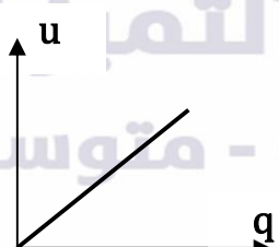
العلاقة بين الطاقة الكهربائية المخزنة بين لوحين مكثف متصل ببطارية و كمية الشحنة
