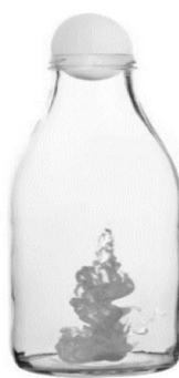
لأن ضغط الهواء خارج القارورة أكبر من ضغط الهواء داخل القارورة ص 67
